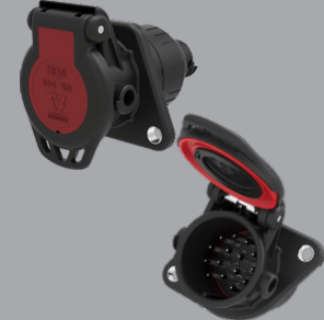
SOCLE PLASTIQUE 15 PÔLES 24 V ADR/EBS Ref. ERIC 141247 100 % étanche. ADR ISO 12098. Pour Volvo FH,FM - RENAULT.
