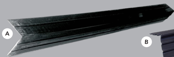
A CORNIÈRE ÉCONOMIQUE 2,40 M Ref. DPL 940ECO 2,40 m - Polyéthylène HD Épaisseur 5 mm - 2400 x 170 x 130 mm
