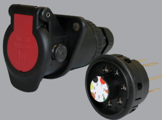
SOCLE PLASTIQUE 7 PÔLES 24 V ADR/ABS/EBS Ref. ERIC 141070 À vis. Avec marquages des codes couleurs pour une affectation rapide.
