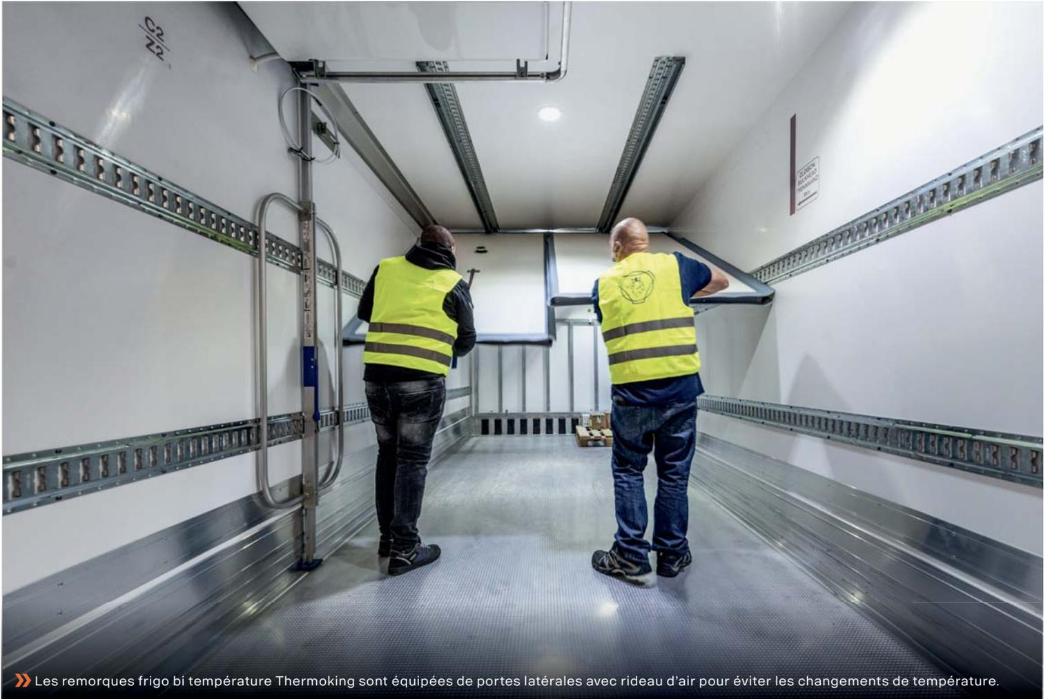
» Les remorques frigo bi température Thermoking sont équipées de portes latérales avec rideau d'air pour éviter les changements de température.
