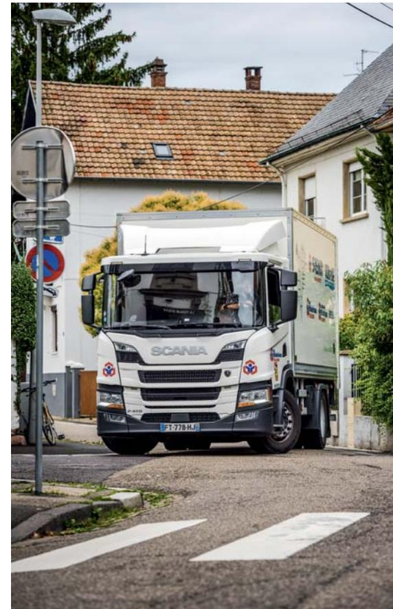
▲ L'empattement très court (3600 mm entre les deux essieux) et le porte-à-faux réduit permettent au Scania de circuler avec aisance dans les centres-villes les plus étroits.
