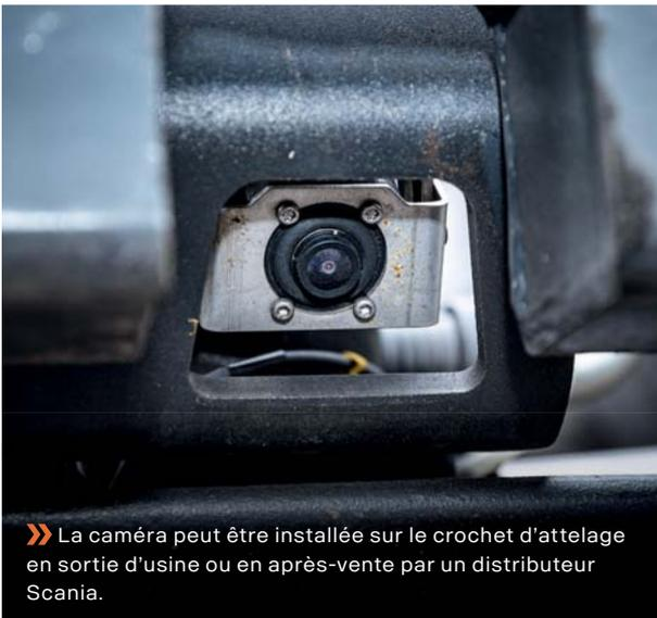
» La caméra peut être installée sur le crochet d'attelage en sortie d'usine ou en après-vente par un distributeur Scania.
