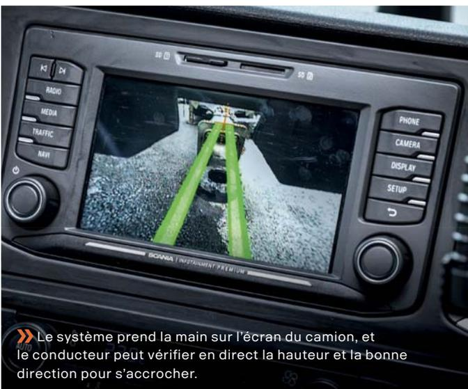
» Le système prend la main sur l'écran du camion, et le conducteur peut vérifier en direct la hauteur et la bonne direction pour s'accrocher.
