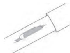
Le non alignement de la suspension est à l'origine du raclement de l'amortisseur. L'amortisseur est soumis à des forces latérales et/ou à des forces longitudinales excessives.
