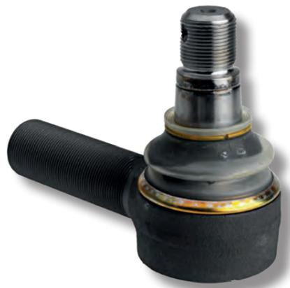
Les rotules doivent être remplacées en cas de signe de jeu ou de grippage ou si le joint en caoutchouc est endommagé. L'axe de rotule est sous tension de ressort vers la surface d'appui supérieure. Pousser la rotule vers l'axe de rotule pour contrôler l'usure.
