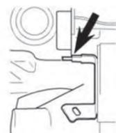
Position de l'étrier de frein lorsque les plaquettes de frein sont usées de façon modérée.
