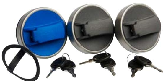
**Kit de bouchons de remplissage Scania : 2x verrouillables, FAME et 1x AdBlue**
