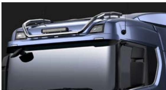
**Rampe de feux de toit Scania pour toit normal, longue sans LED**
