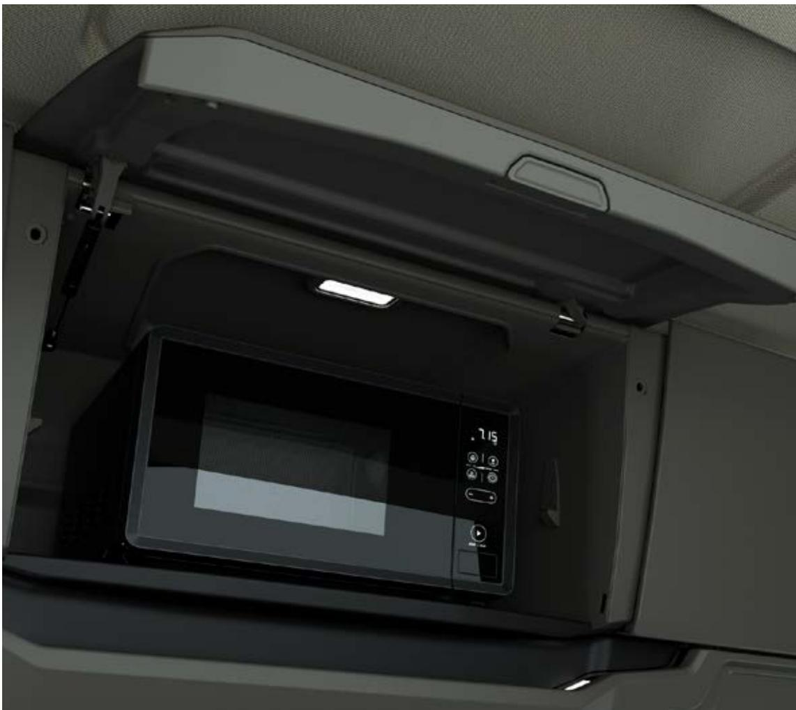
**Four à micro-ondes avec onduleur intégré NTG**
