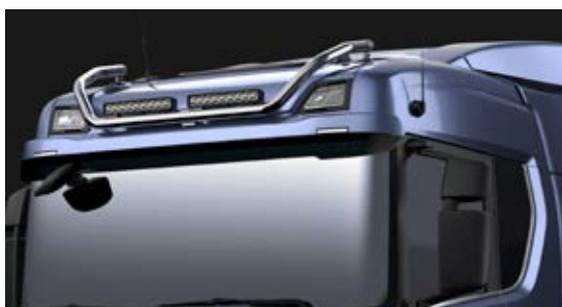
**Rampe de feux Scania pour toit normal, courte, sans LED**
