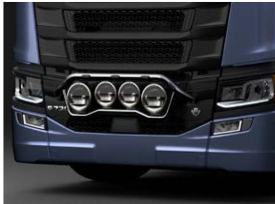
**Kit de rampe de feux avant, avec LED + 4 x lampes Luminator Chrome**
