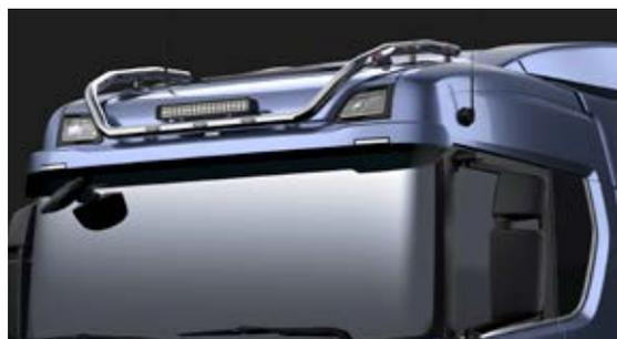
**Rampe de feux Scania pour toit normal, longue, avec LED**
